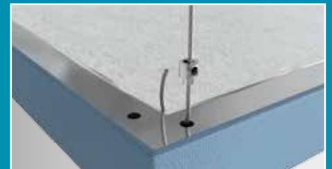
1. Le système d'accrochage en suspension au plafond à l'aide de câbles en acier, permet au panneau phono-absorbant d'être efficace des deux côtés. La suspension offre la possibilité de positionner le Phonolook à de différentes hauteurs et selon différents angles d'inclinaison. Un câble en acier est introduit à l'intérieur des trous se trouvant sur le châssis du panneau en en assurant l'ancrage et la tenue.
